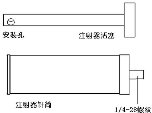
图 1-2, 注射器部件
