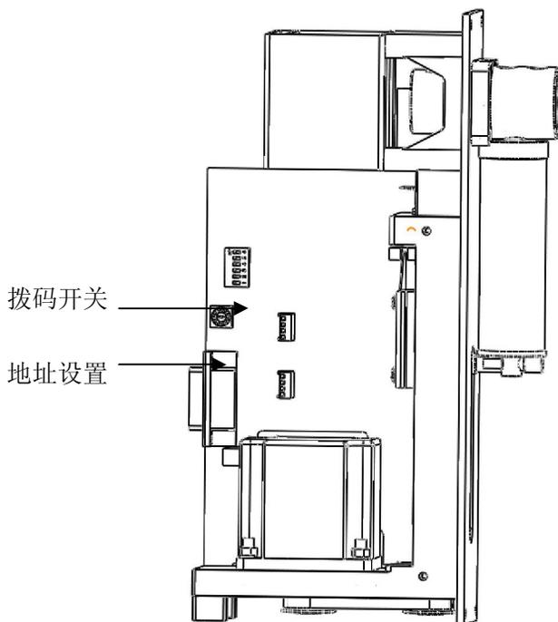
图 1-4 MSP60-1A 印制电路板的外部接口
