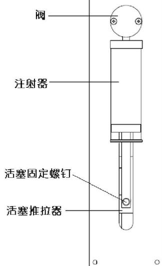
图 2-7 注射器安装图
