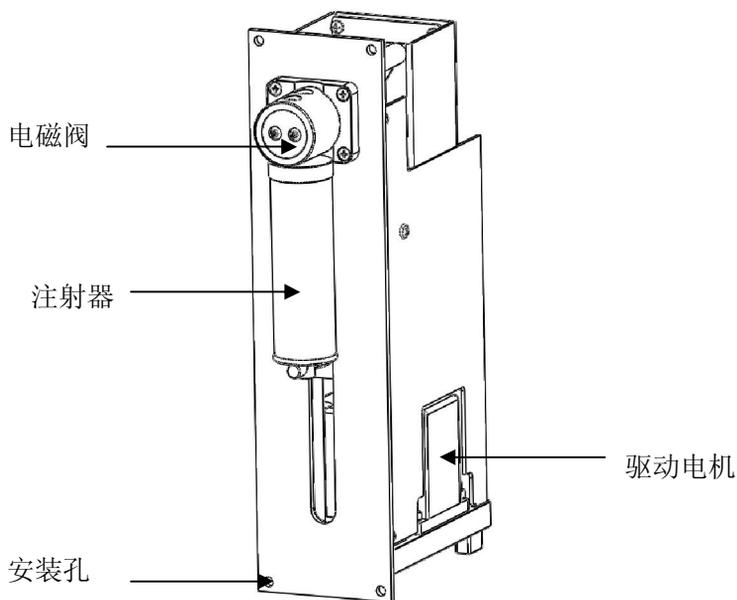
图 1-1, MSP60-1A 注射泵整机部件
